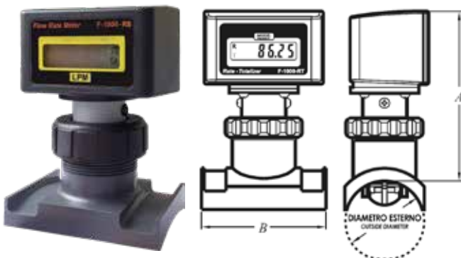
Монтаж / Installation ВХОД 10 x I.D. - ВЫХОД 5 X I.D.
