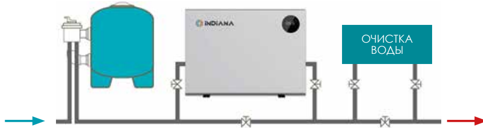
Рис. 3: Схема подключения насоса и системы
